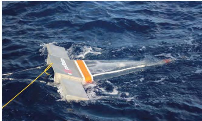
**Manta-Trawl.** Oberflächenproben werden gesammelt
