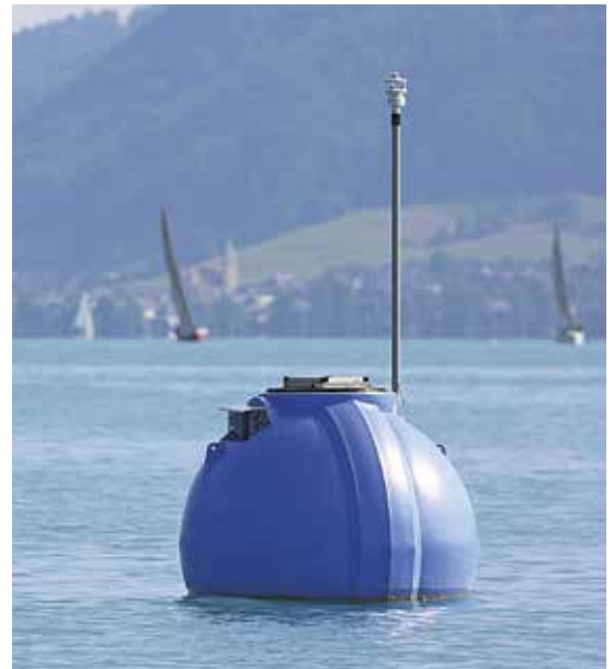
Blaue Kugel. Regatta-Bahnmarke und Wetterboje mit Live-Daten in einem
