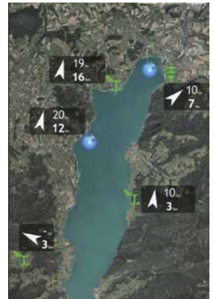
Windmessung. Zwei Messpunkte auf Bojen und vier an Land
