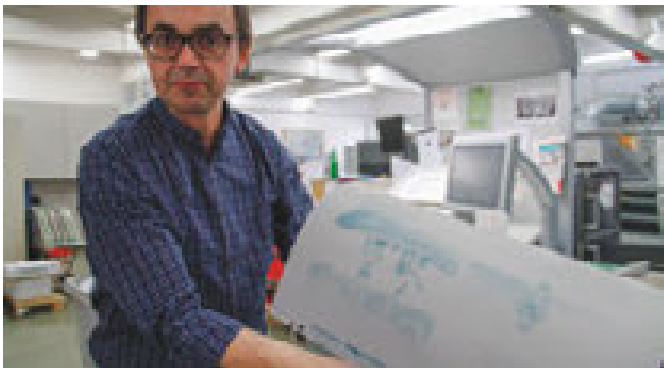
Druckplatten. Zuerst werden für jeweils 12 Seiten die Druckplatten für die vier Farben erstellt
